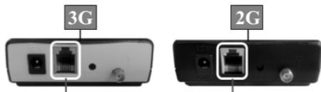
Interface FXS - Conexão com telefone analógico ou linha telefônica.
