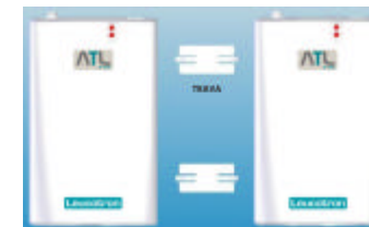
Figura5 – Fixação de dois aparelhos ATL IP
