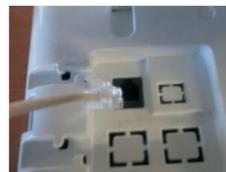
3. Conecte a outra ponta do conector RJ11 a uma porta de ramal digital das centrais ISION IP ou ACTIVE IP.
