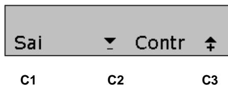
2. Use a tecla da posição **C2** para diminuir o contraste e a tecla da posição **C3** para aumentar. Ajuste a visibilidade no ponto mais confortável, estando você na posição de uso do Terminal Inteligente orbit.go. São 8 níveis de ajuste para o contraste. Para sair do menu **Contraste**, pressione a tecla da posição **C1**.
